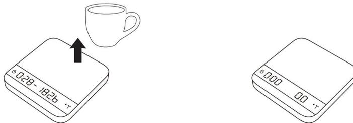
3. En todos los modos de inicio automático, el temporizador se detendrá cuando se detecte un peso negativo (al retirar la taza).
